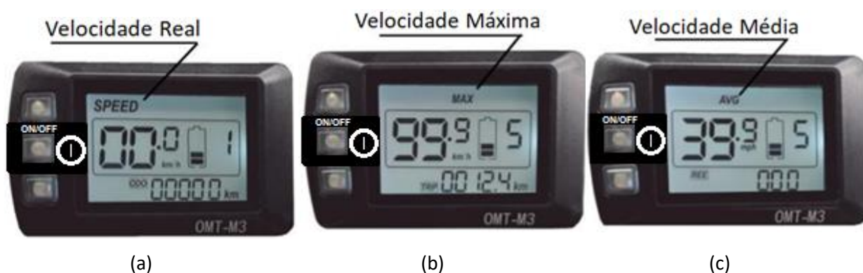
Figura 21 - Informações de velocidade: a) Velocidade em tempo real; b) Velocidade Máxima; c) Velocidade Média
